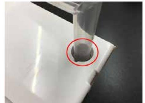
注意点；穴側の窪みとL字パイプ側の突起位置を合わせてから挿入して下さい。
